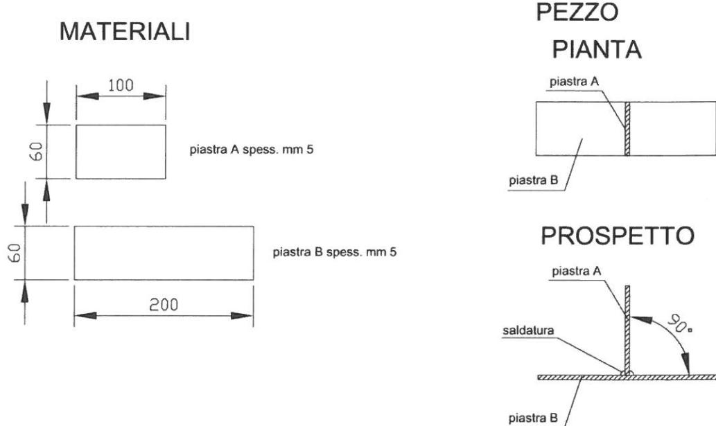
Attrezzi necessari: Saldatrice elettrica
